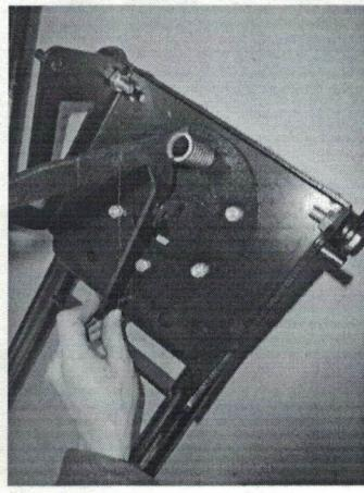
**3.6.** Соедините навеску и отвал с помощью болта, шайбы, гайки, так чтобы дистанционная увеличенная шайба Ø35 оказалась внутри отверстия отвала.
